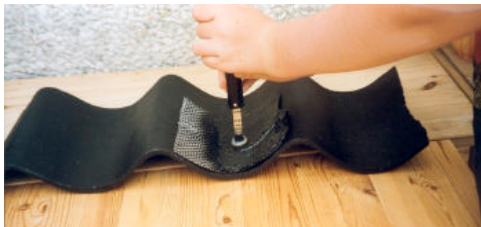
Måling af deformationstryk samt tilbagefjedring
