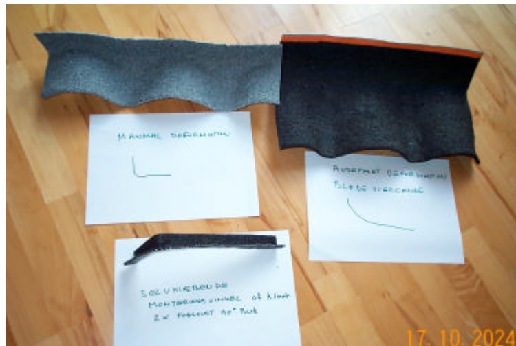
Eksempel på maximal og anbefalet deformation samt en selvklæbende multifleksibel monterings-flange
