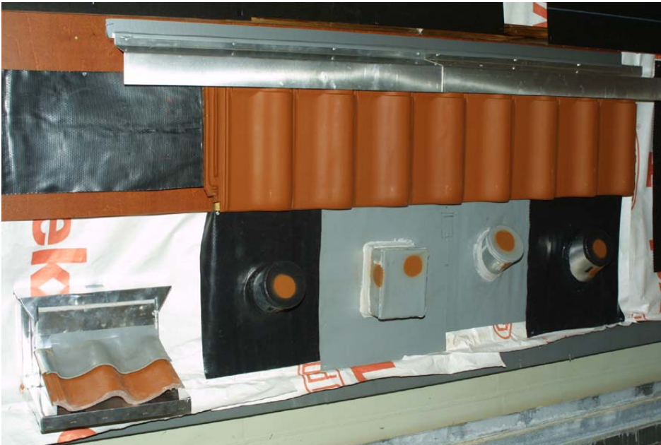
Figur 1. Prøveemnerne monteret i By og Bygs klimasimulator.
