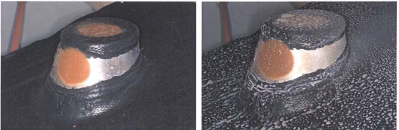
Figur 7. Prøveemne med konisk gennemføringselement udført i aluminium før (til venstre) og efter (til højre) påvirkning i By og Bygs specielt opbyggede prøvestand (der er kalkplatter på prøveemnerne, fordi der er benyttet postevand).
