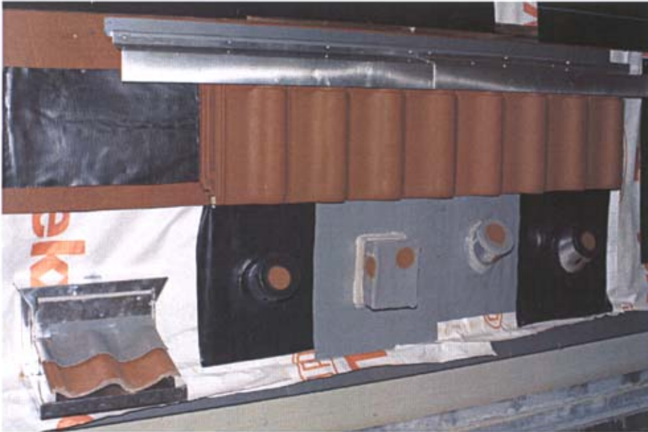
Figur 1. Prøveemnerne monteret i By og Bygs klimasimulator.
